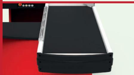
**Modulo anteriore** con nastro a doppia tela nera in PVC antistatico e poliestere. Motore ad alta potenza di trascinamento, raffreddamento ad olio, partenza graduale opzionale. Fotocellule a doppio sensore per una maggiore sicurezza.
